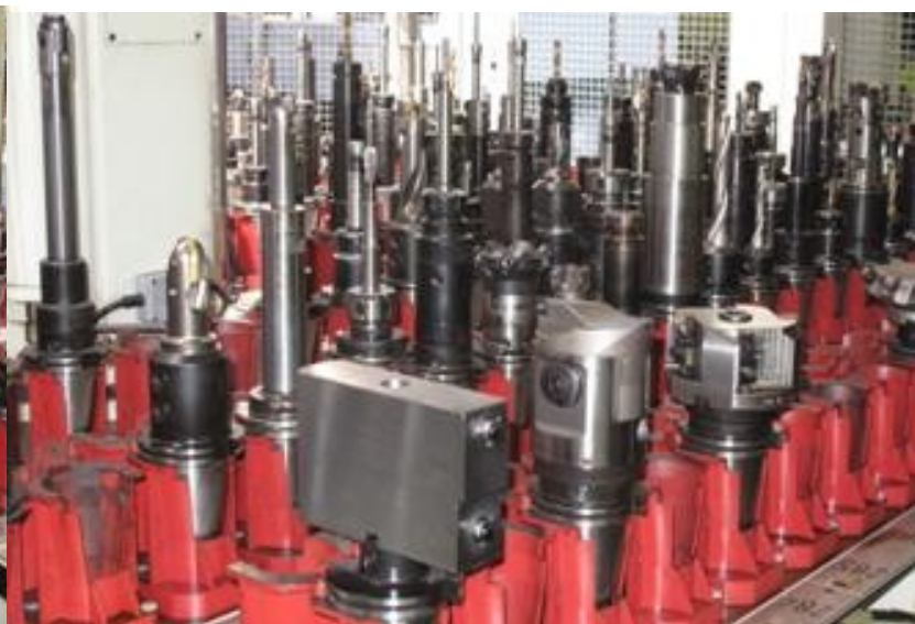
Le magasin de la nouvelle cellule flexible peut accueillir 292 outils !!! Les palettes équipant cette machine sont au nombre de neuf, de 800 par 800 mm et d'une masse admissible de 2000 kg.
