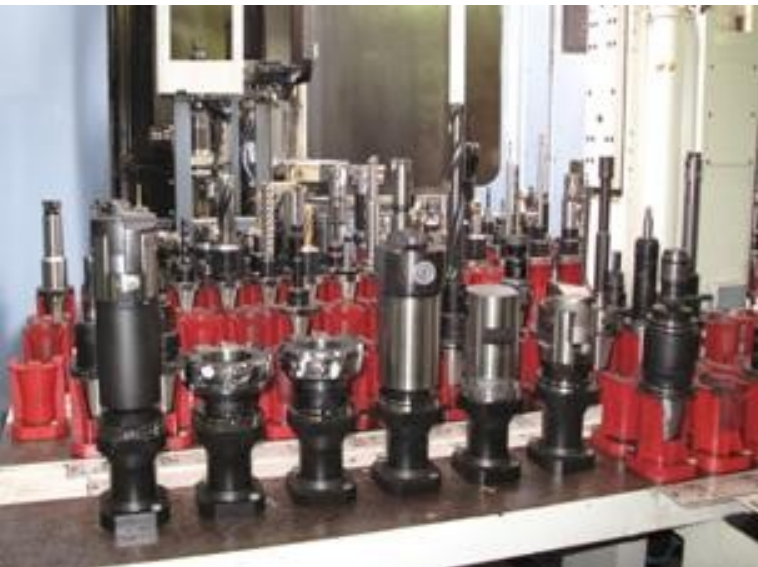
Le magasin de la nouvelle cellule flexible peut accueillir 292 outils !!! Les palettes équipant cette machine sont au nombre de neuf, de 800 par 800 mm et d'une masse admissible de 2000 kg.
