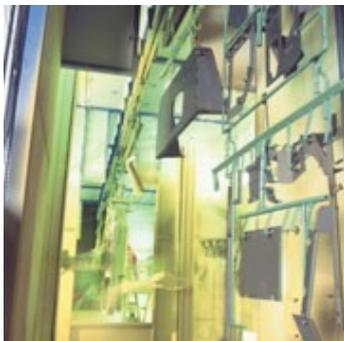
La ligne de montage est placée juste à côté de la sortie de la ligne de peinture et elle est alimentée par les différents modules qui composent la mini pelle.
